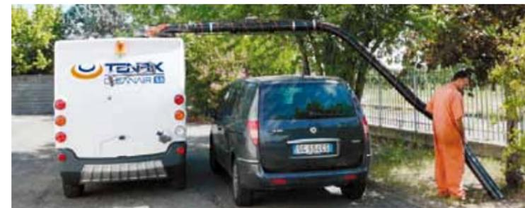
Montato su ralla per la massima funzionalità, il tubo di aspirazione supplementare è lo strumento efficace per la raccolta del fogliame, dei rifiuti in zone di difficile accesso e per la rapida pulizia di pozzetti e caditoie.
