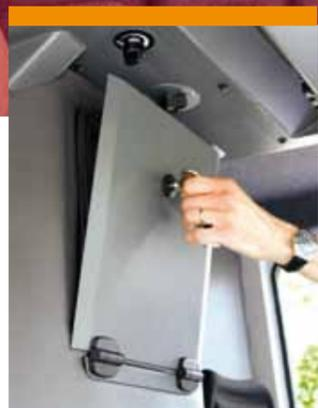
*In cabina sono presenti un'ampia vetratura a pavimento per il controllo della zona di lavoro e un portello per l'ispezione del condotto di aspirazione.*
