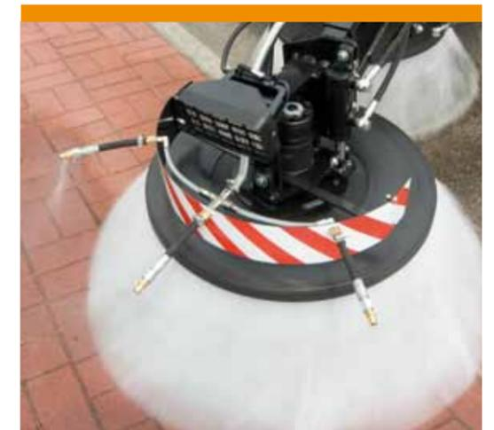
*Il sistema di abbattimento polveri con ugelli nebulizzatori posizionati sulle spazzole ed all'interno della bocca di aspirazione è alimentato da un serbatoio in acciaio inox Aisi 304 di grande capacità.*
