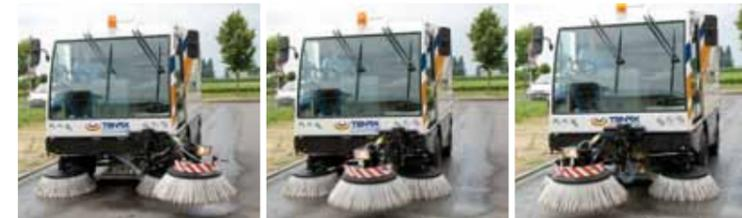
La terza spazzola frontale brandeggiante a traslazione idraulica assicura un ancor più ampio fronte di spazzamento e consente di raggiungere il rifiuto nelle posizioni più difficili e su piani posti ad altezze diverse da quello stradale.
