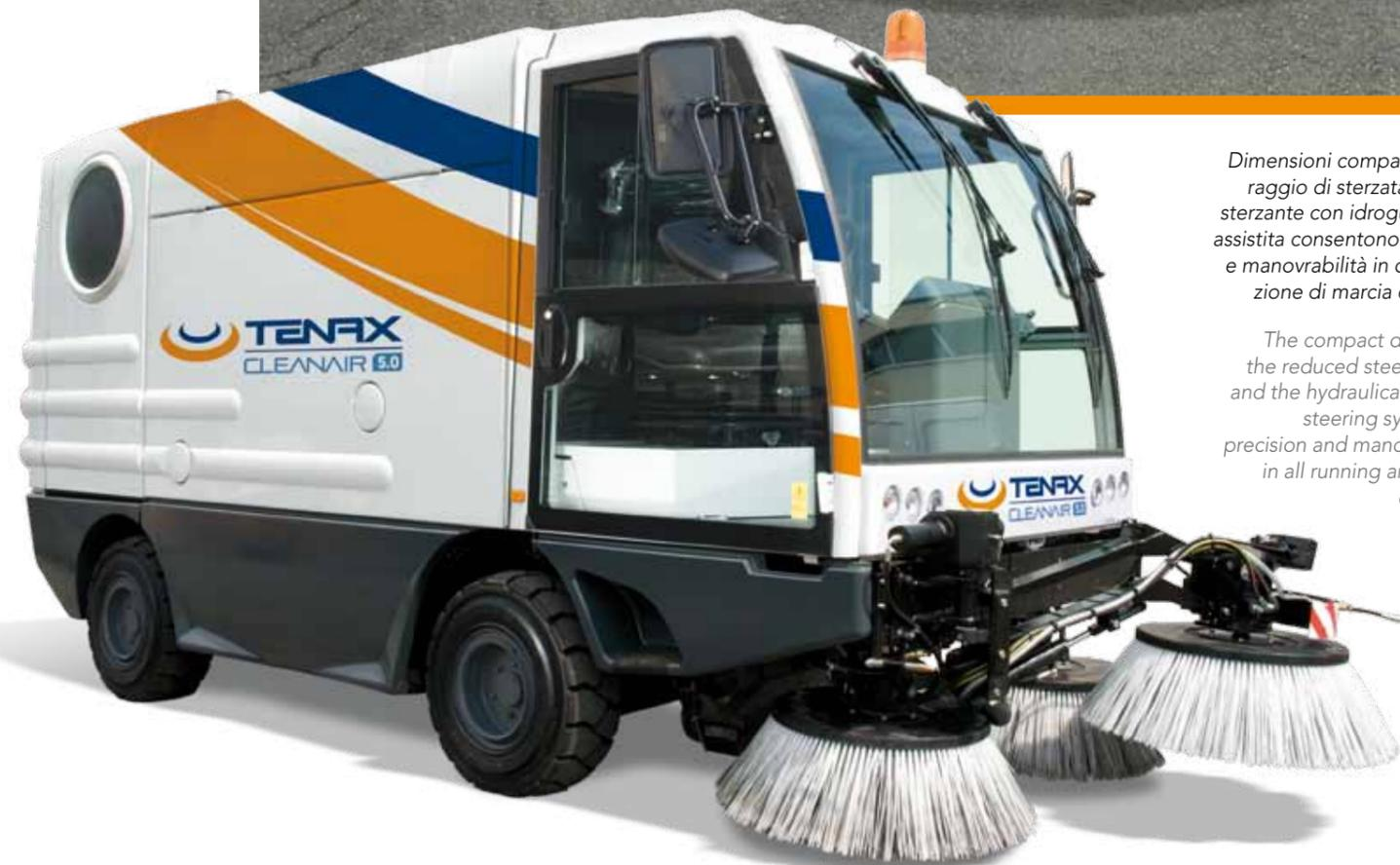
Dimensioni compatte, ridotto raggio di sterzata e sistema sterzante con idroguida servoassistita consentono precisione e manovrabilità in ogni condizione di marcia e di lavoro.
