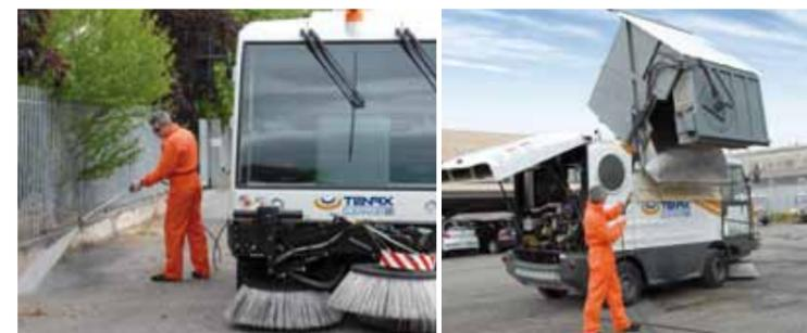
Il sistema di lavaggio ad alta pressione (140 bar) è di grande utilità nelle operazioni di manutenzione urbana e per la pulizia della macchina a fine lavoro. Disponibile anche su braccio rotante.
