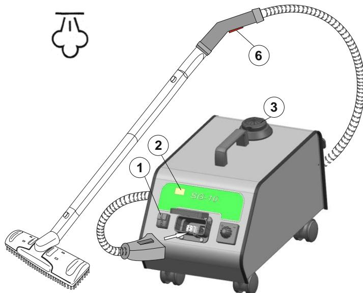
Cuando la máquina estará lista, para producir vapor de agua a través del mango de la manguera, pulse el botón de palanca (6). Ahora operan el cepillo o accesorio en las superficies a limpiar.
