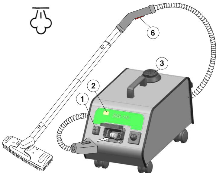
Quando la macchina sarà pronta, per erogare vapore tramite l'impugnatura del flessibile, premere il pulsante a leva (6). Azionare ora la spazzola o l'accessorio nelle superfici da pulire.
